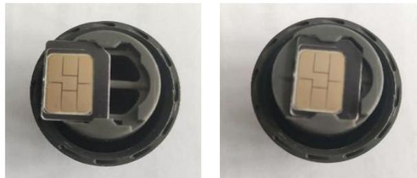
图 2.3.3-2 SIM 卡安装示意
