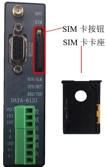
图 2、按下 SIM 卡按钮，取出卡架
