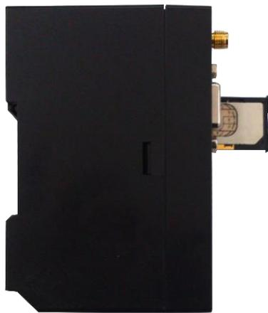
图 3、将 SIM 卡放入到卡架上，并将卡架放回模块中
