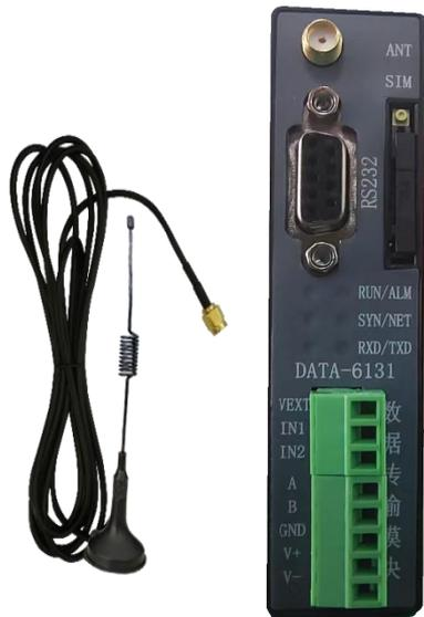
图 1、打开包装，取出吸盘天线和 DATA-6131 模块
