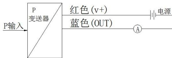
4-20mA电流输出接线图（二线制）
