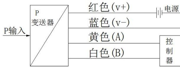
RS485输出接线图（四线制）
