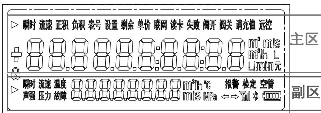
超声水表主屏默认显示正累积流量和瞬时流量。顶部状态栏显示多种信息提示符号，代表设备运行相关状态，提示标识含义如下：
